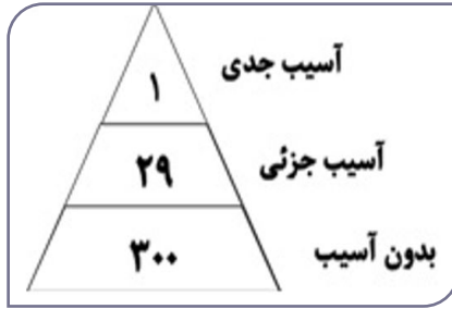
شکل ۲-۳. نسبت حوادث با شبه حادثه و آنومالی‌ها مطابق با نظریه هنریچ
